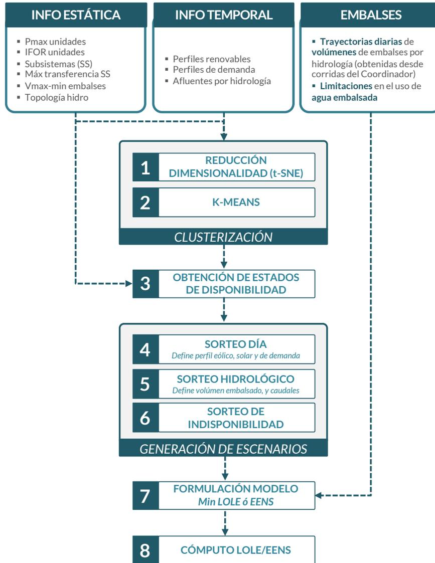
Figura 6. Descripción metodológica de submodelo operativo para simulación de fallas y cómputo de probabilidad de pérdida de carga (Fuente: SPEC/ISCI).
